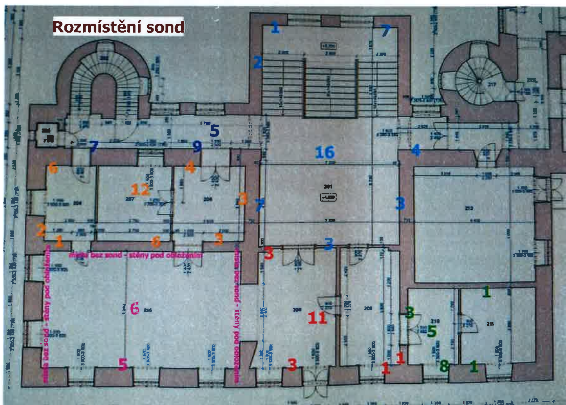
Rozmístění sond v částech zámku, kde proběhl restaurátorský průzkum
