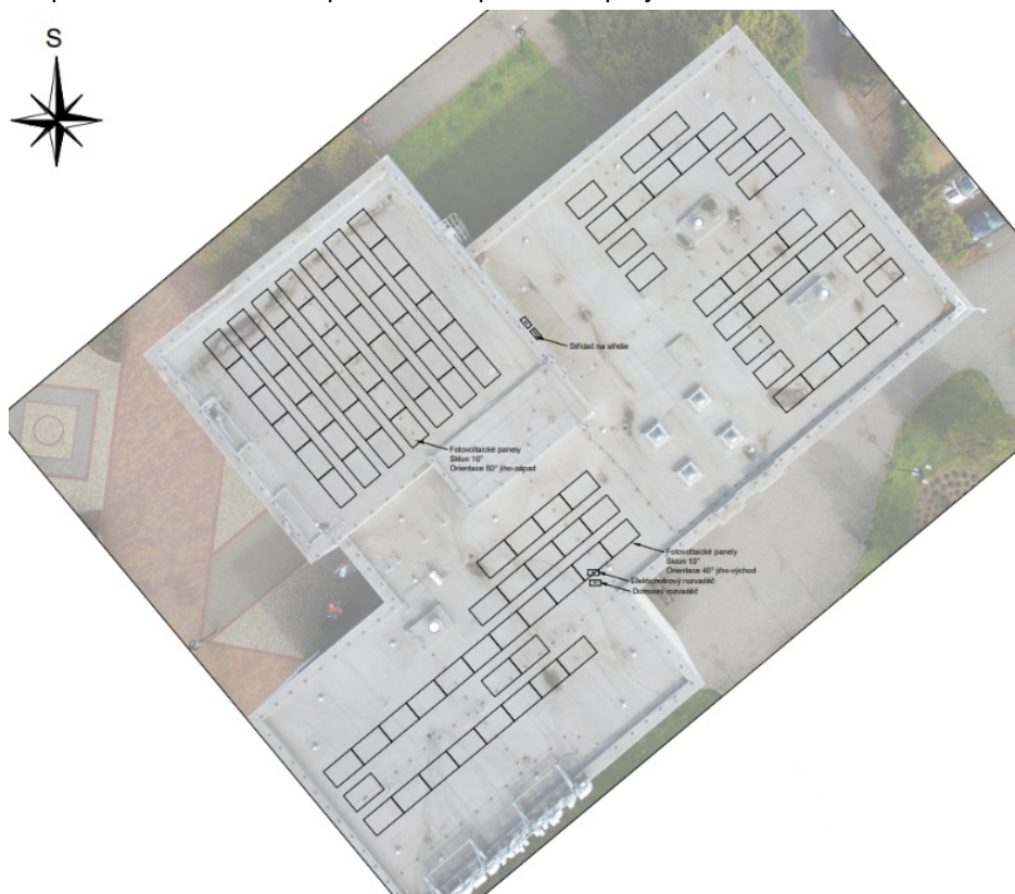
Obr. 5 Rozmístění FV panelů na střechu objektu
