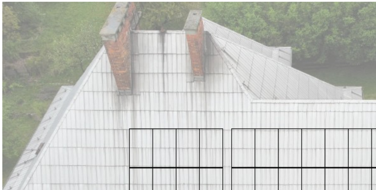
Obr. 8 Rozmístění FV panelů na střechu objektu
