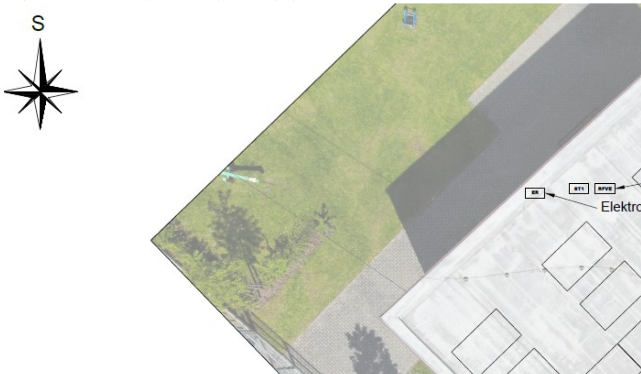
Obr. 2 Rozmístění FV panelů na střechu objektu
