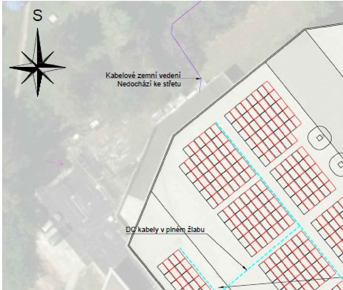
Obr. 7 Rozmístění FV panelů na střechu objektu
