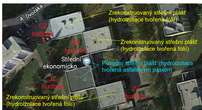
obr. /19/ Schéma střešních plášťů
