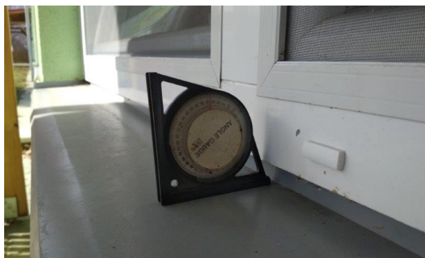
obr. /25/ Při vizuální prohlídce nebylo nalezeno okenní oplechování, které by nemělo dostatečný spád
